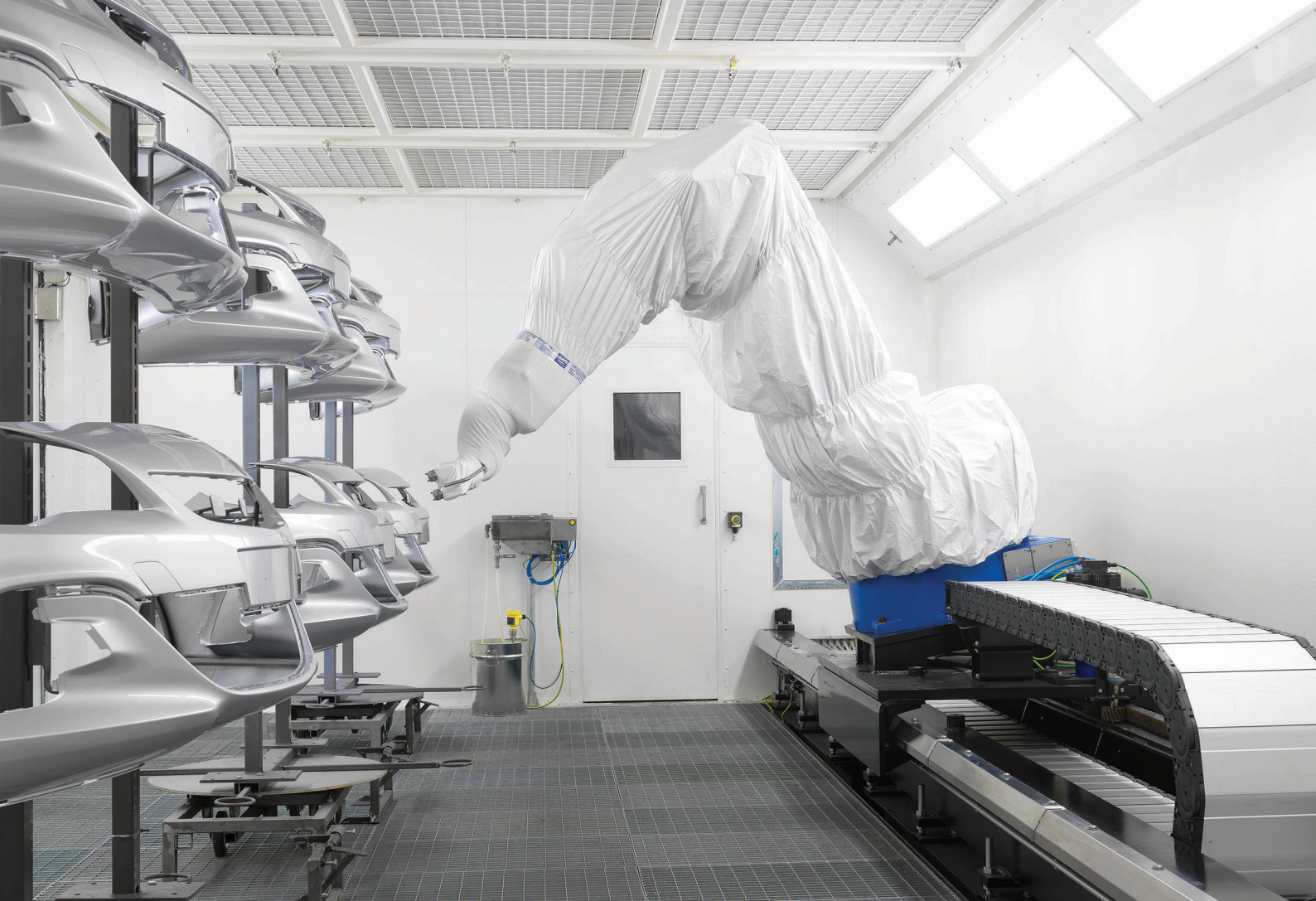
Ein Lackierroboter lackiert mehrere Frontpartien von Pkw. Bild: KSK Industriellackierungen
